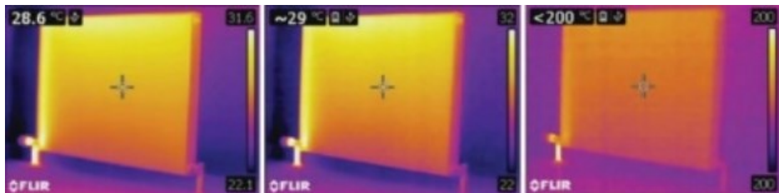
Figura 29. Imágenes termográficas con rangos de temperatura de -20 a +120°C (izquierda), 0 a 650 °C (centro) y +250 a +1200°C(derecha). Las demás configuraciones de la cámara no cambian (Heymans, 2019).
