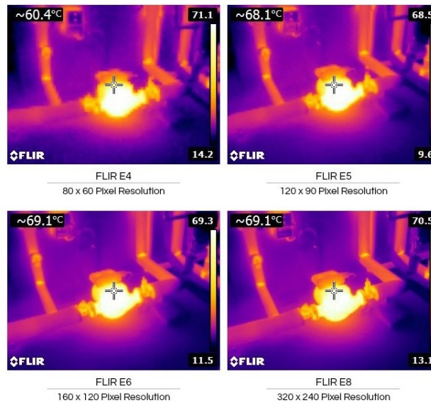
Figura 28. Comparación de imágenes del mismo sistema a diferentes resoluciones (FLIR, test-meter.co.uk, 2019).
