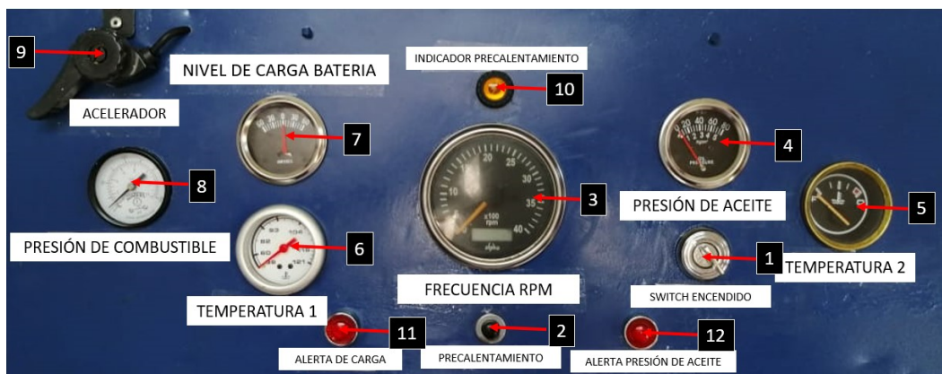
Figura 3: Identificación componentes del tablero de control.
