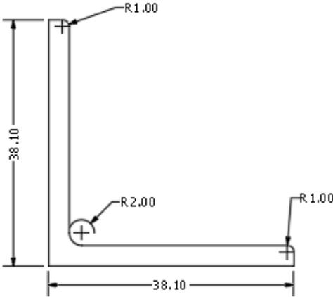
**PERFIL ANGULO UTILIZADO EN CAJA CONTROL MOTOR**
