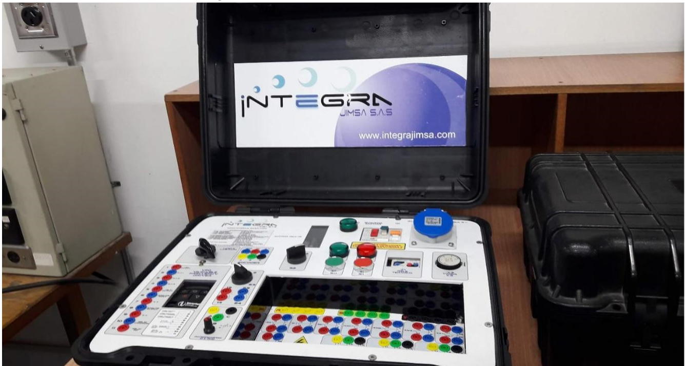
Fig. 1: Vista general del módulo variador de velocidad
