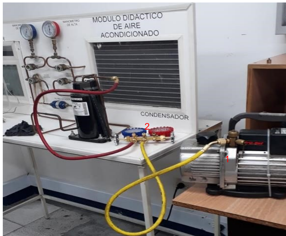
Figura.1- 4: Proceso de vacío al módulo de aire acondicionado
