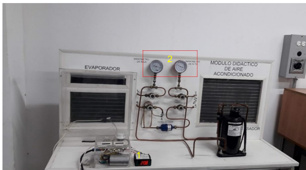
Figura. 1-7: Módulo de aire acondicionado en estado final y operativo.
