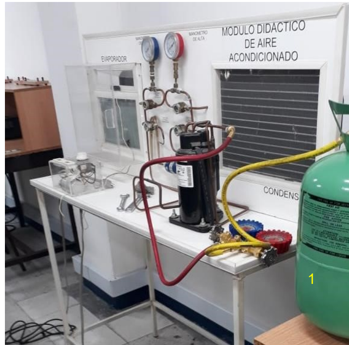
Figura. 1-6: Proceso de llenado del módulo de aire acondicionado con refrigerante R22.
