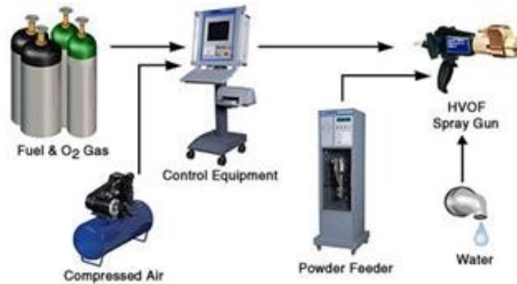
Figura 6. Estructura de control de HVOF. Fuente: (Diaz, 2009)
