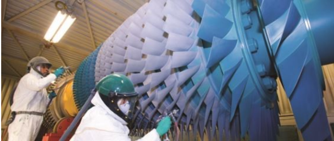
Figura 1 .Aplicación recubrimiento a una turbina a gas. Fuente: (SULZER, 2016)
