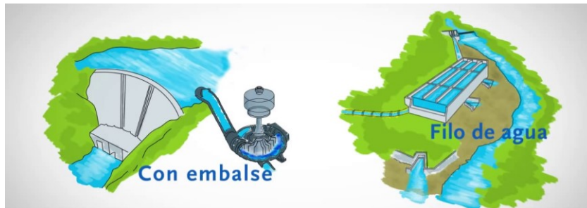
Figura 9. Diferencia entre una central con embalse y filo de agua. Fuente: (ISAGEN, 2017)
