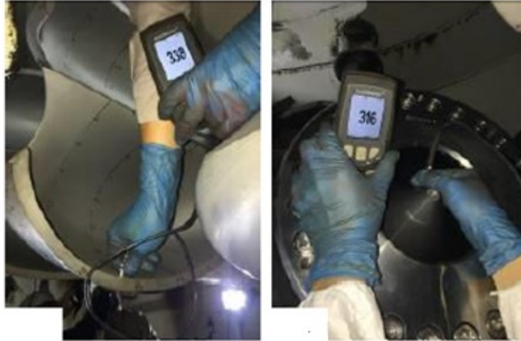
Figura 36. Medición de revestimientos en rodete y agujas.
