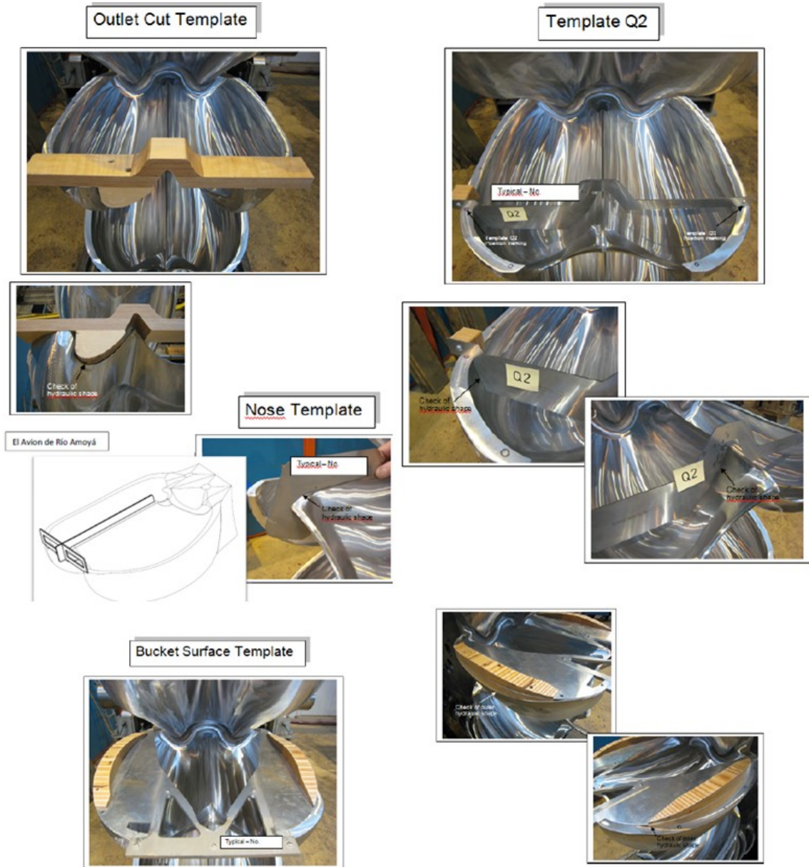
Figura 64. Plantillas para medir la pérdida de material en el cangilon.
