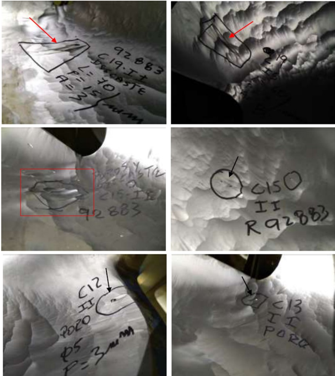
Figura 41. Desgaste avanzado en cangilones.
