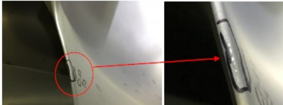
Figura 50. Falta de recubrimiento en el cangilón 1.
