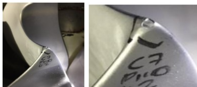
Figura 48. Falta recubrimiento cangilon 7.
