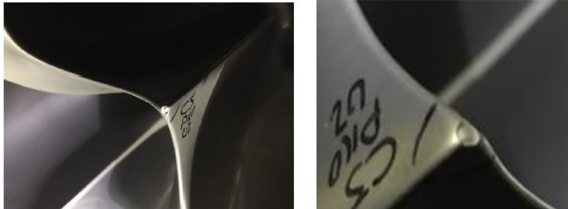
Figura 46. Falta de recubrimiento en el cangilón 5.
