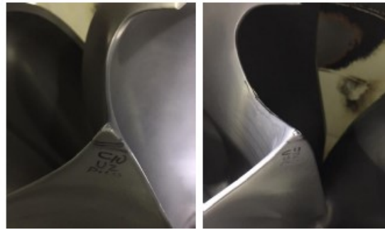
Figura 49. Falta de recubrimiento en el pico de los cangilones 10 y 11.
