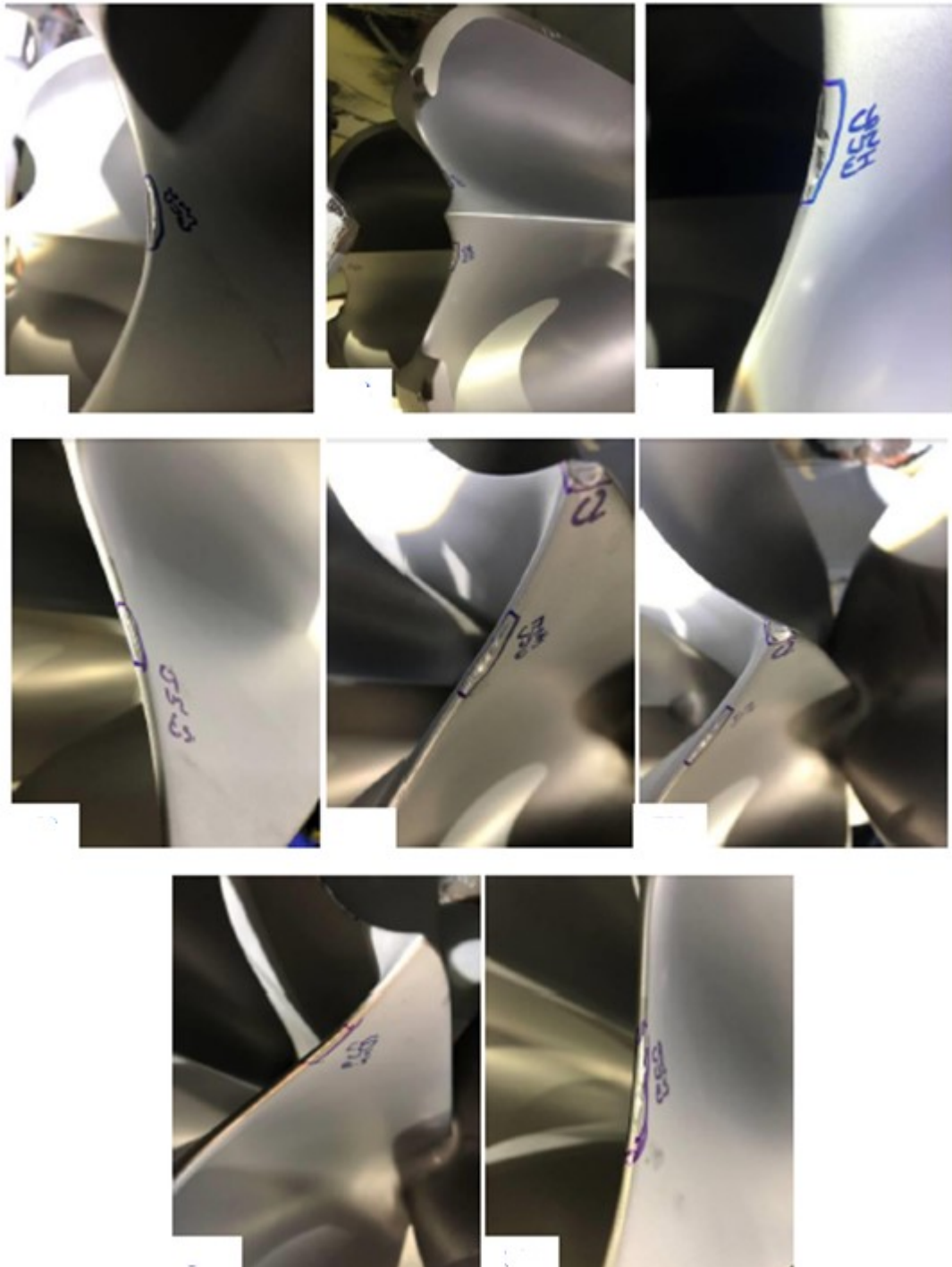
Figura 60. Falta de recubrimiento cangilon 6 y 7.
