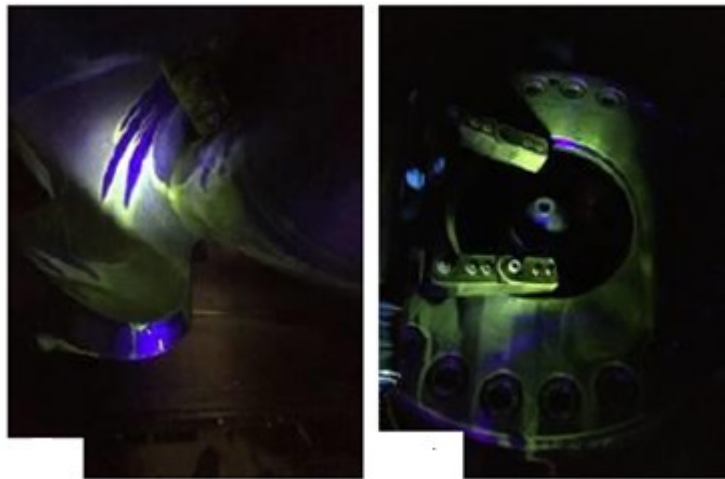
Figura 35. Inspección con partículas magnéticas en raíz y boquereles.
