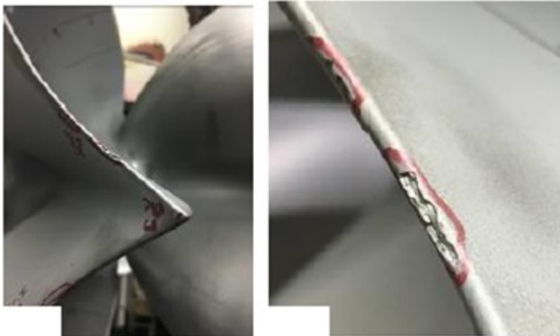
Figura 33. Cangilón 11 con falta de revestimiento en el pico y en los bordes de las escotaduras.
