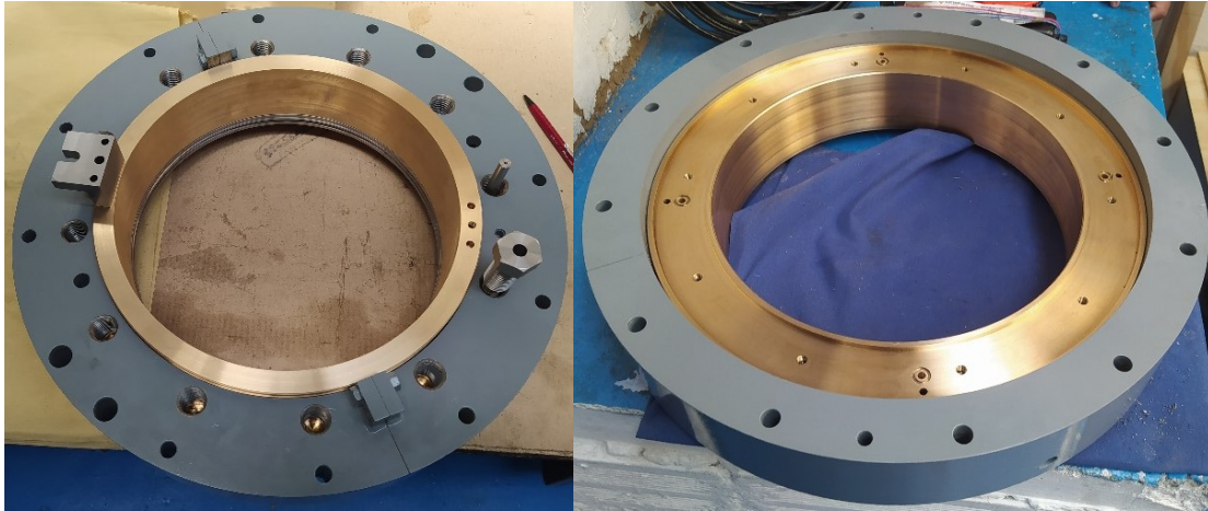
Figura 31. Sello de eje tipo prensa estopa re-diseñado para la turbina de la PCH el Popal.
