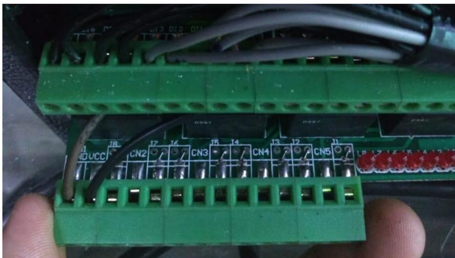
Sosteniendo la tarjeta con las manos, es posible sacarla un poco hacia adelante para observar las marcas y las conexiones. Como todas cargas a energizar son a 24 VDC (relés), es posible hacer un puente entre los comunes de la tarjeta de salidas, en caso de que no fuesen iguales, cada común se debería energizar con una tensión distinta.
