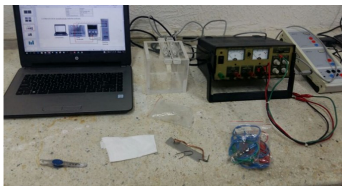
Figura 3-3. Montaje del anodizado de las muestras
