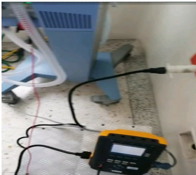
Figura 15. Analizador Fluke conectado al ventilador para realizar pruebas
