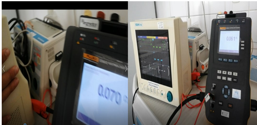
Figura 17. Analizador fluke conectado al monitor de signos vitales para realizar pruebas
