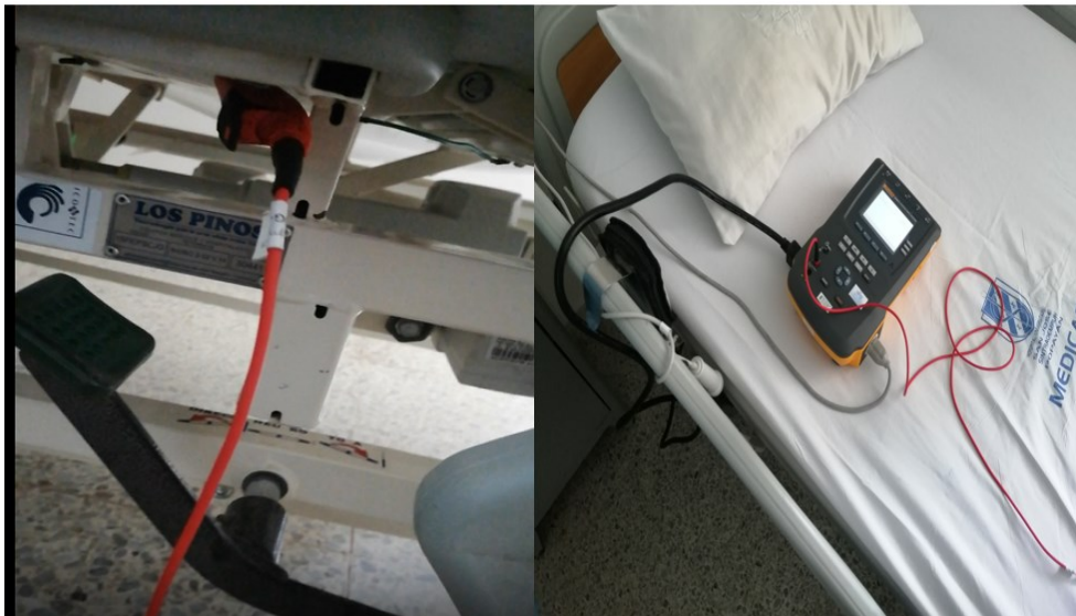
Figura 18 Analizador fluke conectado a Cama eléctrica hospitalaria para realizar pruebas
