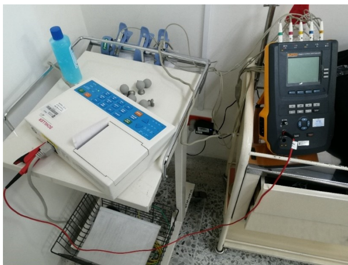
Figura 19 Analizador fluke conectado al Electrocardiógrafo para realizar pruebas
