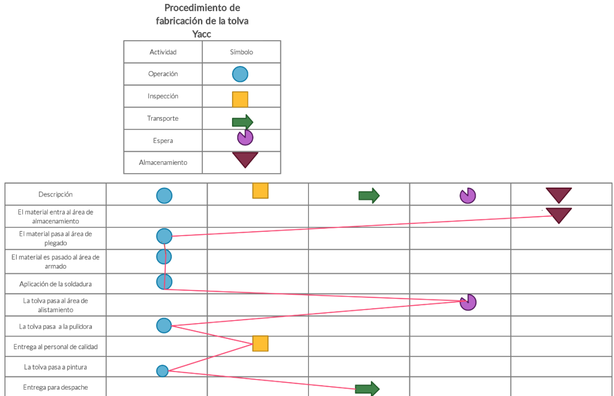
Figura 4. Diagrama de flujo procedimental de la tolva YACC
