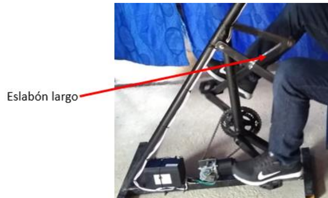
Figura 3- 10 Elemento mecánico – Eslabón largo
