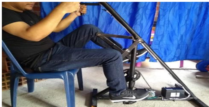
Figura 3- 17 Prueba del prototipo a escala sin elementos ergonómicos.
