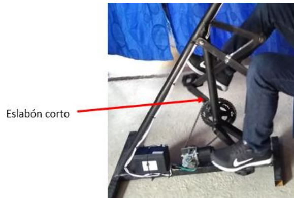
Figura 3- 8 Elemento mecánico – Eslabón corto.
