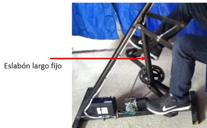
Figura 3- 11 Elemento mecánico – Eslabón largo fijo
