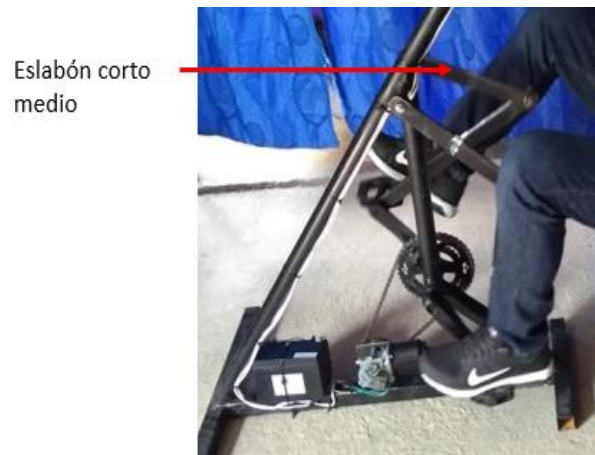
Figura 3- 9 Elemento mecánico – Eslabón corto medio.
