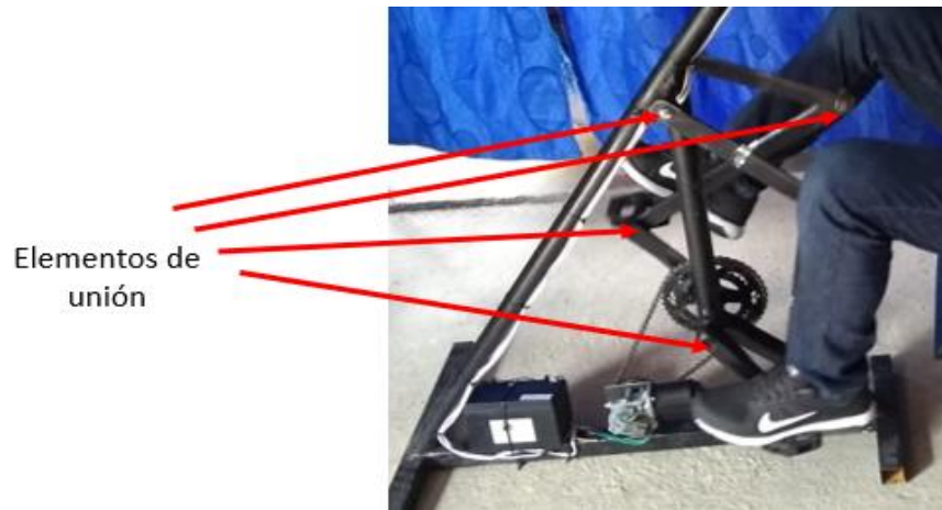
Figura 3- 14 Elemento mecánico – Elementos de unión.
