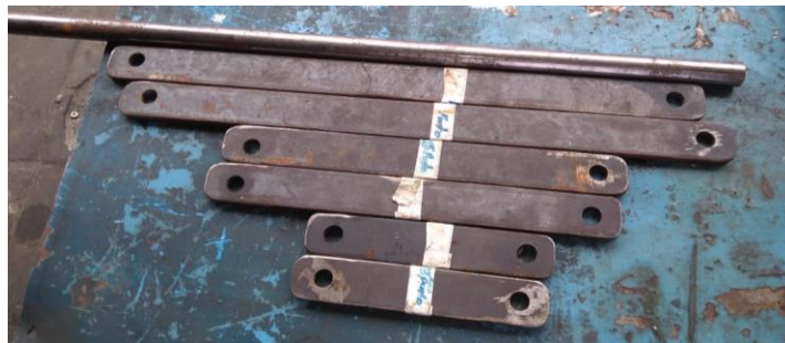
Figura 2- 31 Construcción de los eslabones cortos, medios y largos
