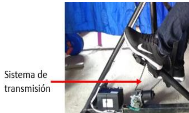
Figura 3- 13 Elemento mecánico – Sistema de transmisión.
