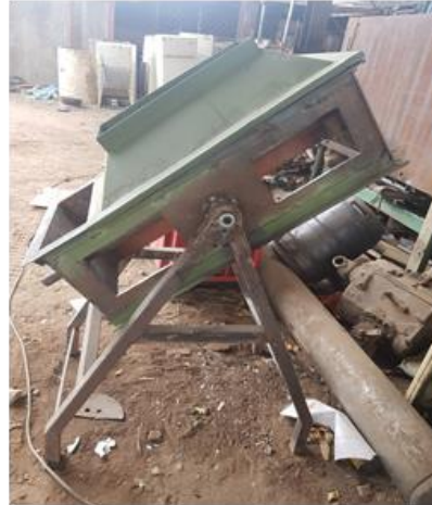
Ilustración 3-3: Ensamble de estructura o chasis maquina descoladora
