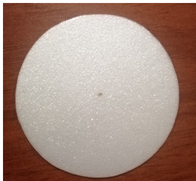
Figura 2-19: Disco para medición de nivel
