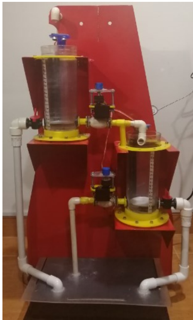
planta de tanques acoplados.
