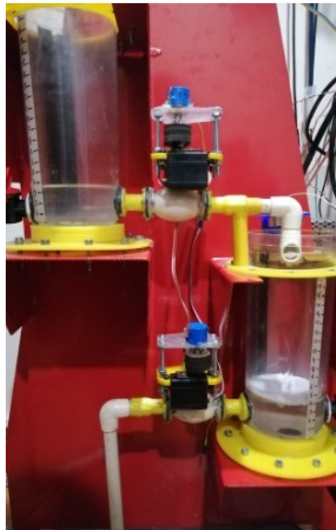
Figura 3-20: Fotografía de tanques acoplados estabilizados.
