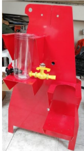
Figura 2-8: Chasis con pintura electrostática.
