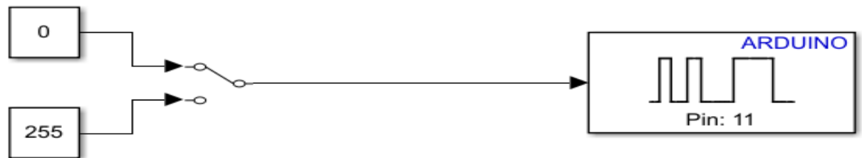
Figura 3-9: Bloque configuración bomba DC
