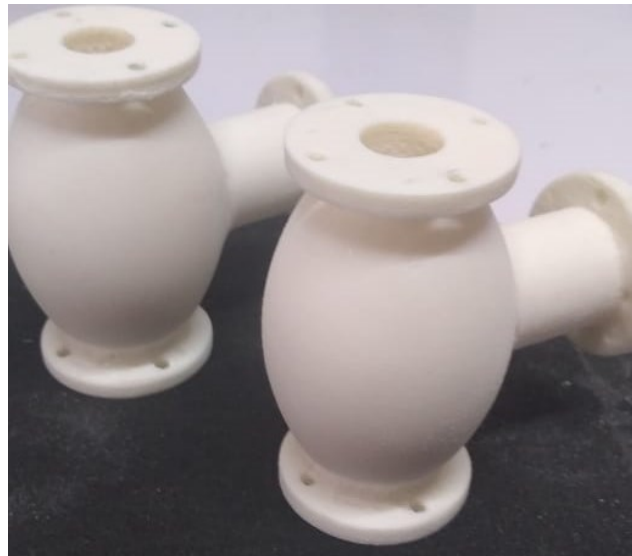
Figura 2-13: Válvulas impresas en PLA
