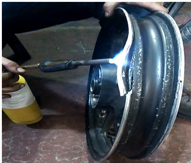
Fotografía 1-2: Proceso de calentamiento de rin deformado
