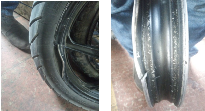
Fotografía 1-1: Deformación de rin CBF 150
