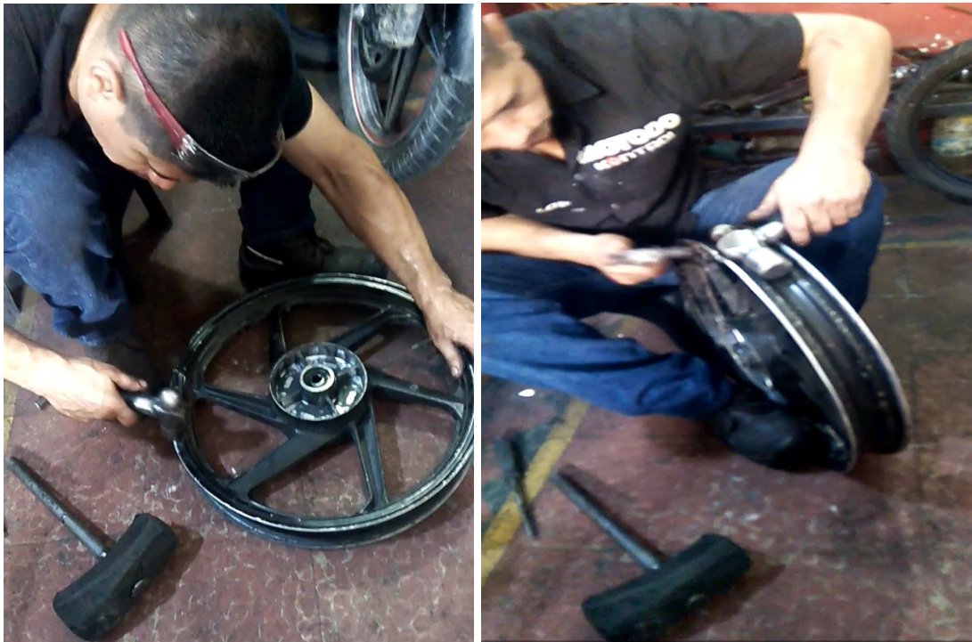
Fotografía 1-3: Martillado y rectificando de Rin
