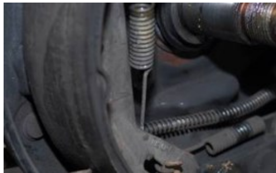
Figura 2-4: Sistema de freno lado izquierdo módulo didáctico
