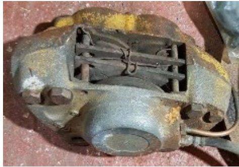
Figura 2-3: Caliper mordaza de sistema de freno actual módulo didáctico
