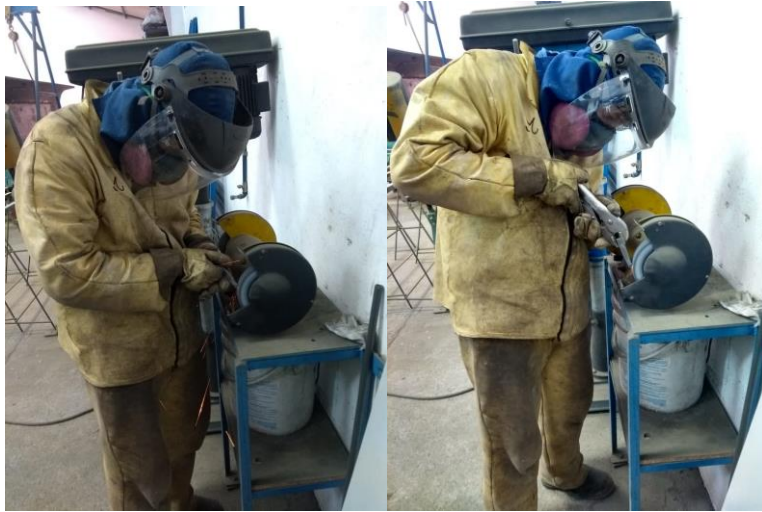
Gráfica 206. Afilado de buriles por medio de esmeril
