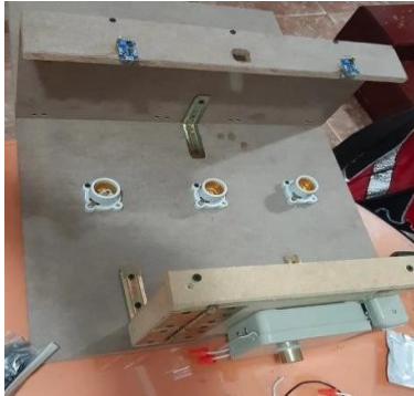
Figura 15. Iluminación, sensores y chapa electromecánica.
