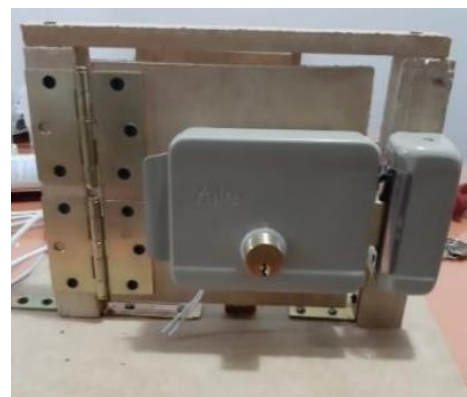
Figura 14. Montaje de chapa electromecánica y accesorios de soporte.
