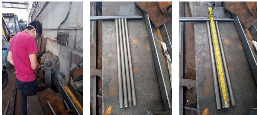
Ilustración 22 Proceso de pulido de los ejes
