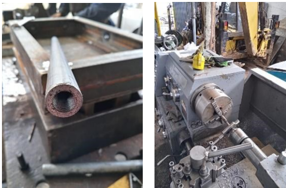
Ilustración 24 Proceso de perforación y maquinado de ejes guías
