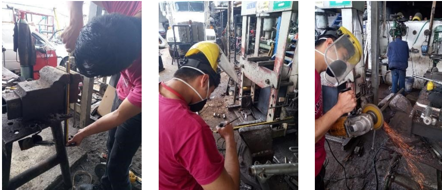
Ilustración 21 Proceso de corte de ejes de guías
