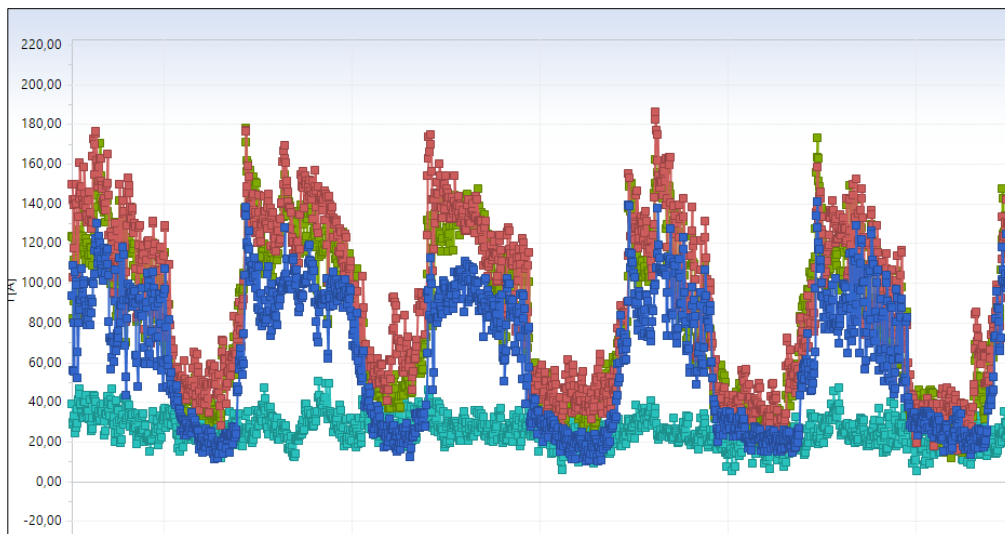
Ilustración 26. Circuito trifásico desbalanceado. Autoría propia
