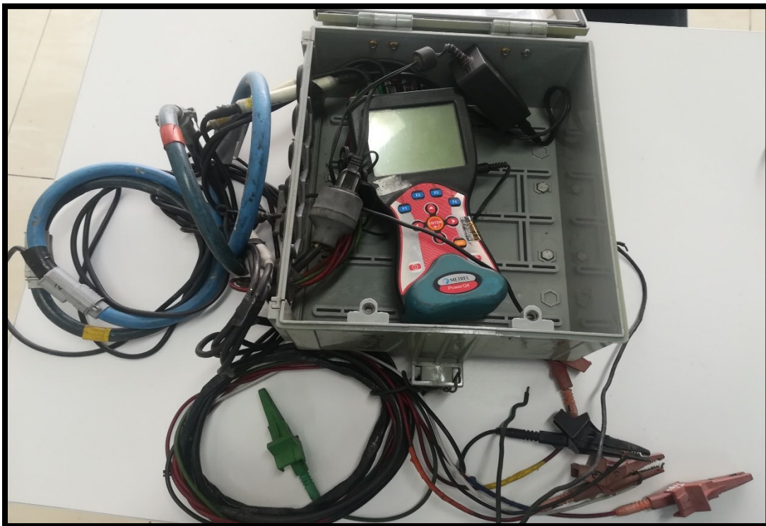
Ilustración 17 Componentes de analizador de red. Fuente propia
