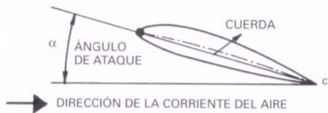
Figura 6. Angulo de ataque con respecto a la dirección del viento (Harpe et al., 2015)
