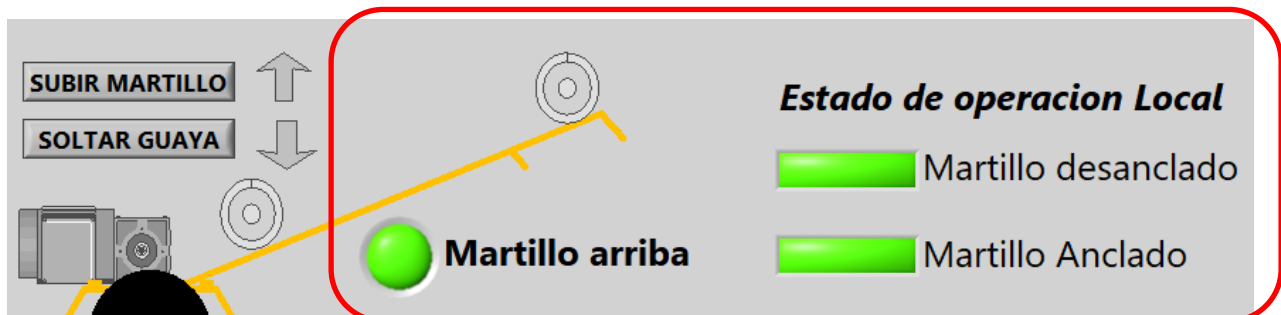
Figura 49 Visualización de sensores de posición en LabVIEW
