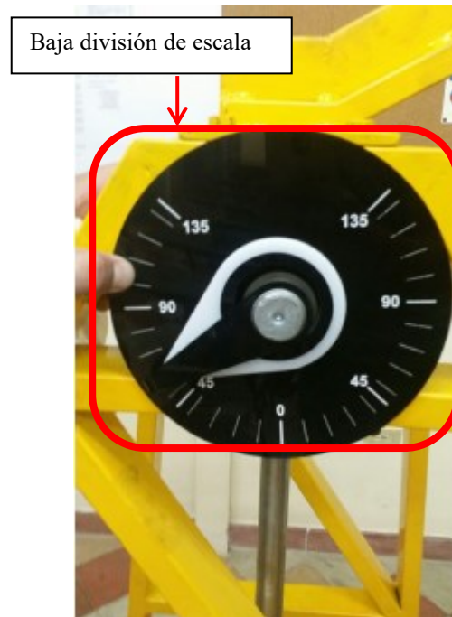
Figura 1 Indicador de ángulo inicial y final del péndulo Charpy
