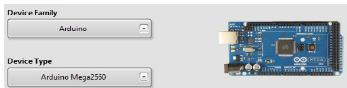
Figura 23 Seleccionar el dispositivo Arduino Mega.
