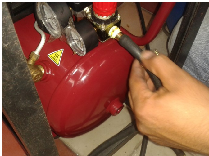
Figura 21 Compresor de cámara de niebla salina.
