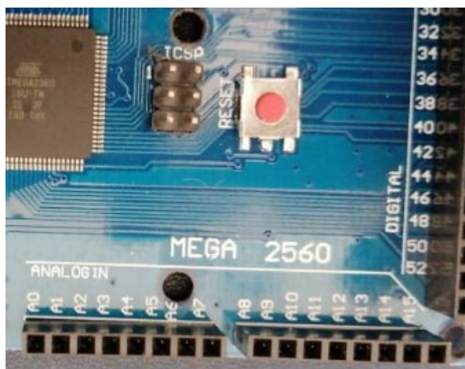
Figura 29 Entradas análogas de microcontrolador Atmel 2560.
