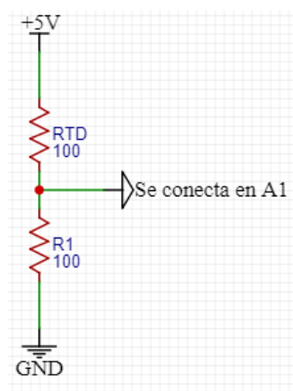
Figura 32 Salida de señal de temperatura del sensor HE-67N2-0N00P
