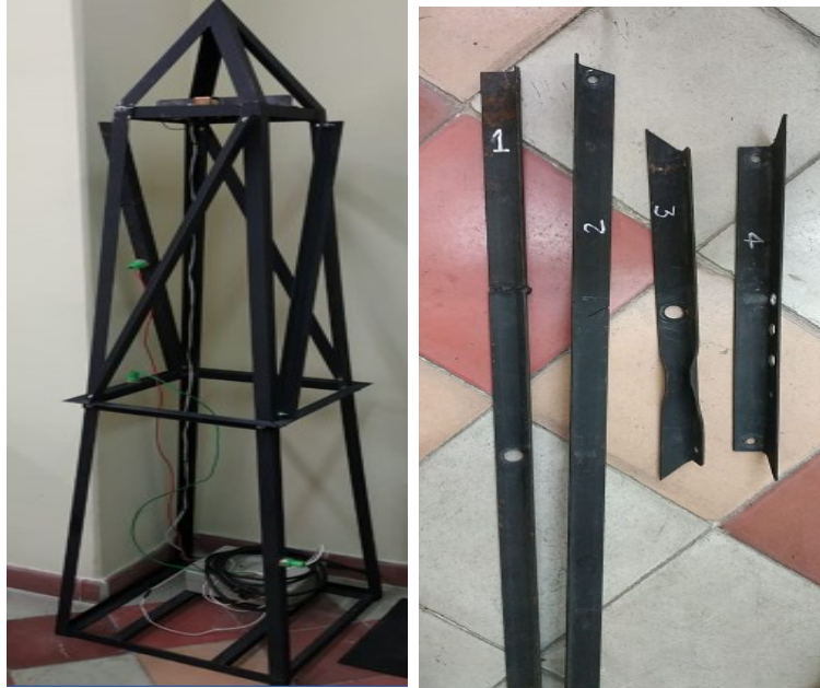
Figura 3-1. Estructura metálica y vigas con alteraciones
