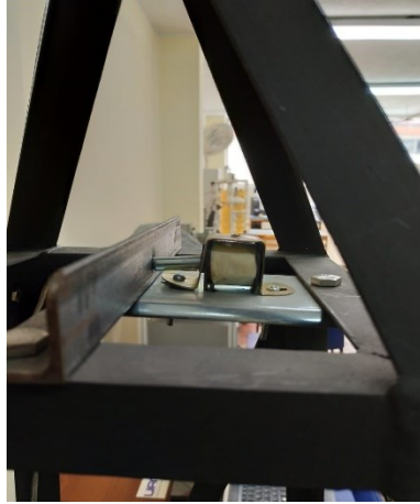
Figura 3-2. Obturador o módulo de excitación
