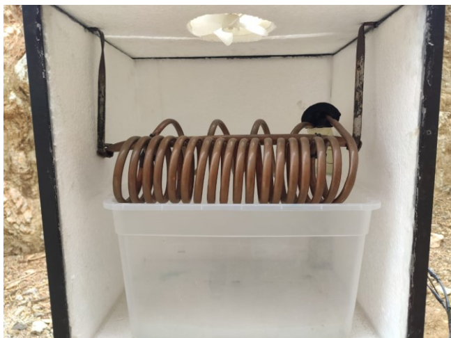
Figura 33: Evaporador, recolector de agua y ventilador para descongelamiento.
