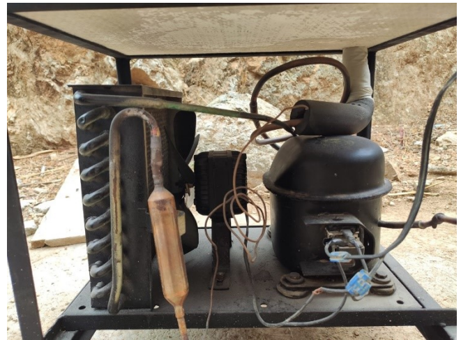
Figura 32: Compresor, condensador, ventilador y tubo capilar del prototipo.
