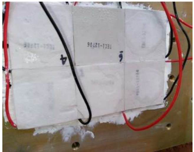
Figura 17: Condensación en Celdas Peltier.
