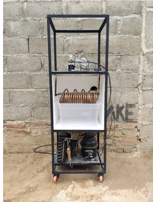
Figura 31: Parte del evaporador y colector de agua del prototipo.
