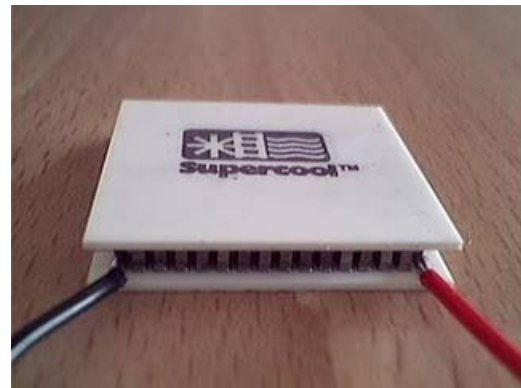
Figura 14: Célula de efecto Peltier.
