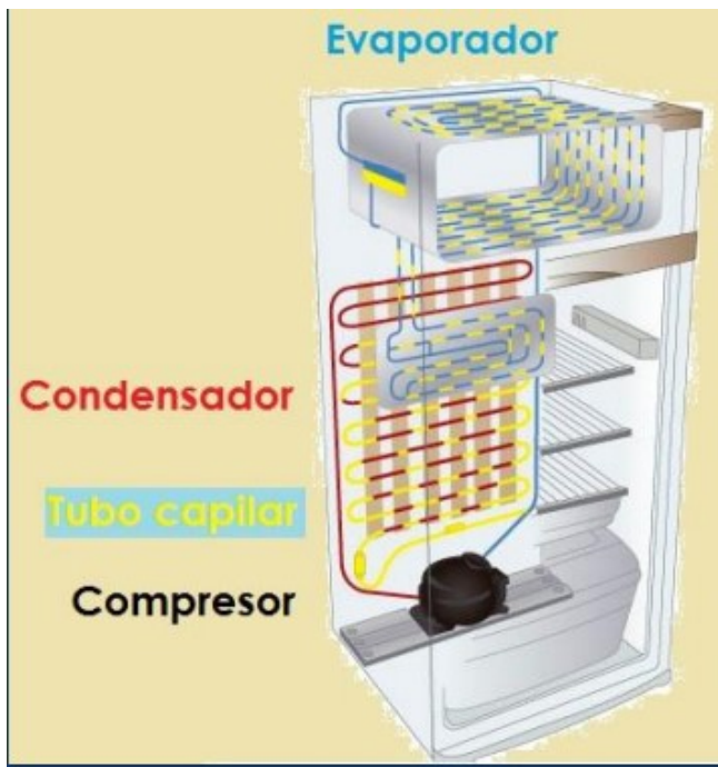
Figura 16: Partes principales del sistema de refrigeración por compresión de vapor.
