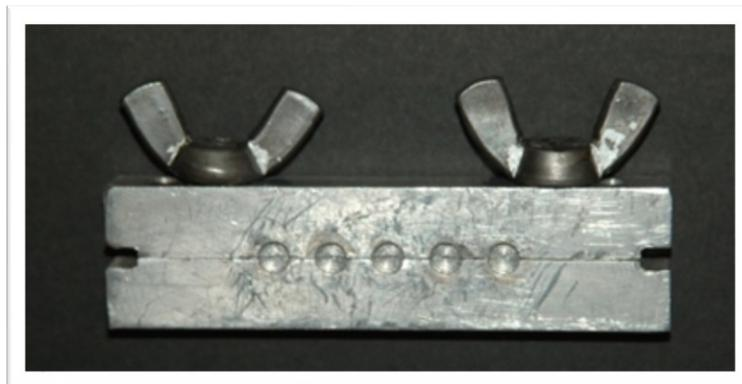
Dicha matriz presenta dos tornillos en la parte externa que permite abrirla en dos partes para hacer más fácil la remoción de los cuerpos de prueba (figura 1).
