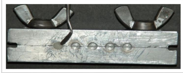
Sobre esta se pone una tira de myllar y una loseta de vidrio para la homogenización del cuerpo de prueba, dicha loseta es retirada antes de la polimerización. (Figura 3)
