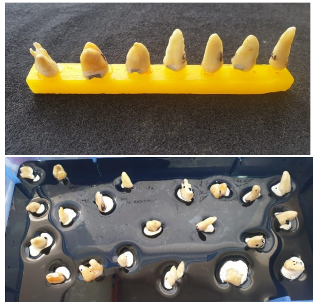
Figura 7. A: Impermeabilización con cianocrilato en el ápice y tres capas de barniz. B: Sumergidas en azul de metileno.
