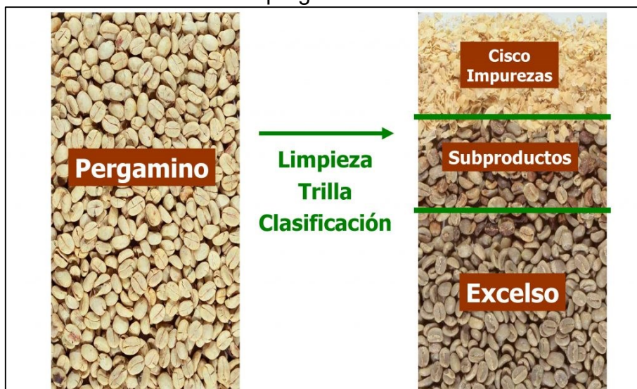
Figura 21. Transformación del café pergamino seco en la trilladora.
