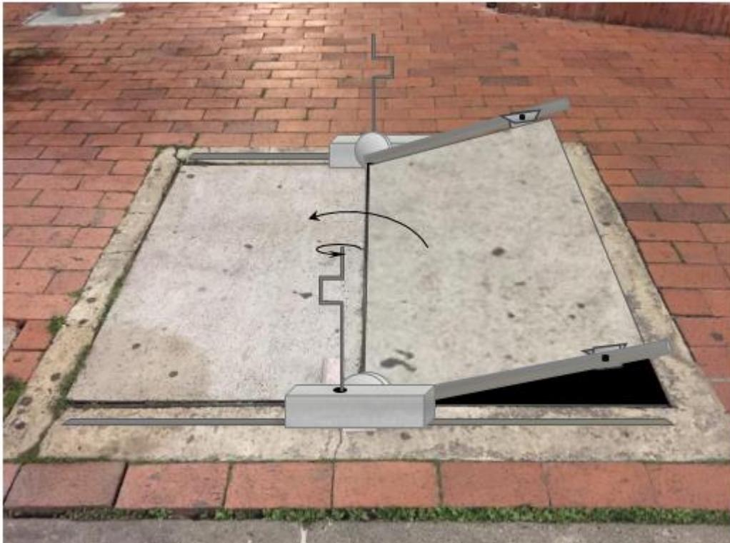
Figura 38: modelo esquemático sistema de izado [Fuente: propia]
