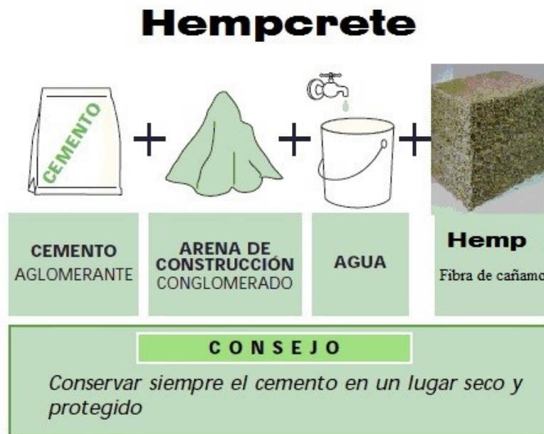
Figura 5. Composición del Hempcrete. Fuente: (Pvma, 2017)
