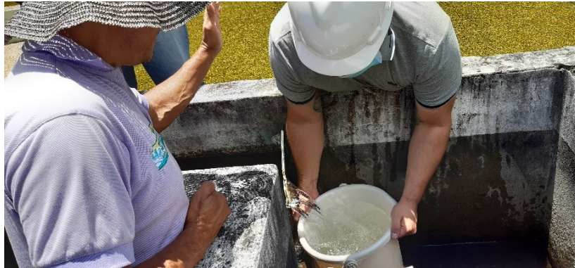
Ilustración 27: Aforo volumétrico en vertedero de entrada a FGA. Fuente: Elaboración propia.
