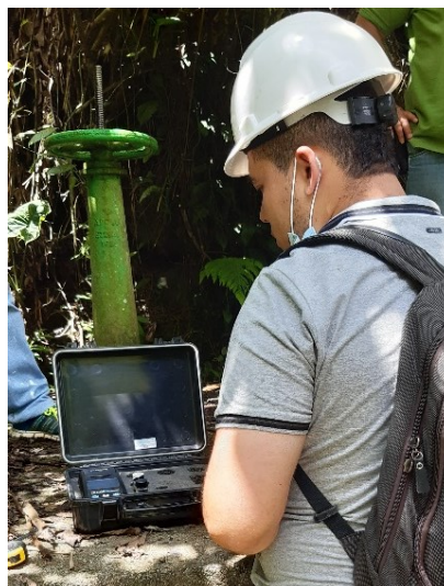
Ilustración 9: Toma de turbiedad en sitio de captación. Fuente: Elaboración Propia.
