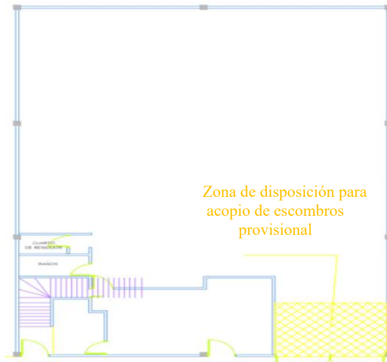
Figura 20 Levantamiento de la primera planta para determinar zona de acopio
