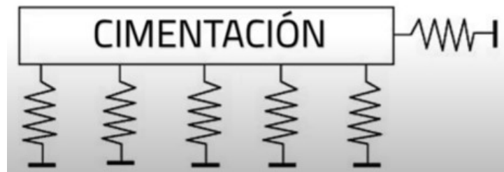
Figura 7. Viga de Winkler 1986. Fuente ( Darío Aristizábal-Ochoa, n.d. )
