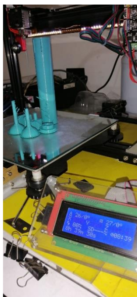
Figura 9. Proceso de impresión del cepillo.
