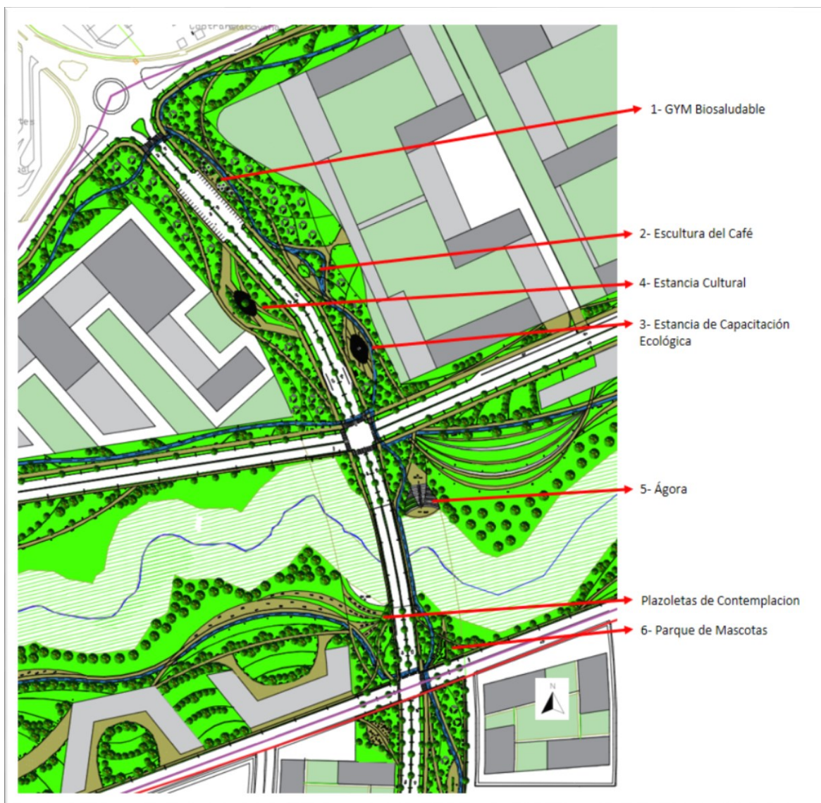
Mapa 61. Plano primera etapa de propuesta del parque lineal en el municipio de Pitalito. Fuente: elaboración propia.
