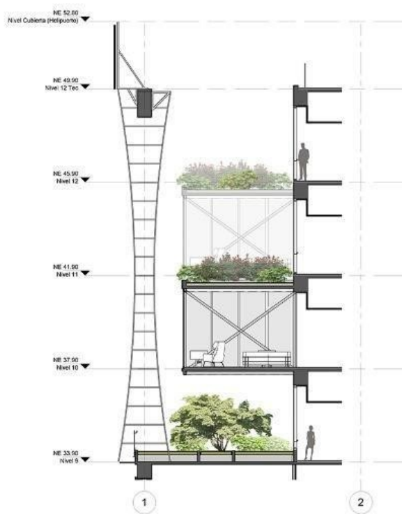
Ilustración 7 REFERENCIA DE FACHADA FLOTANTE
