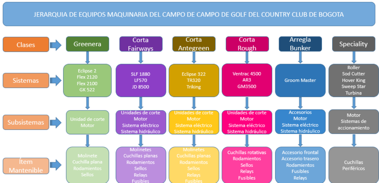
Figura 10. Jerarquía de equipos maquinaria del campo de golf Country Club de Bogotá
