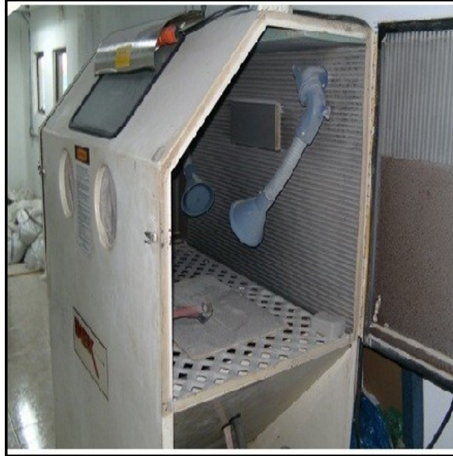
Figura 7.35. Cabinas con adaptación de brazos extractores
