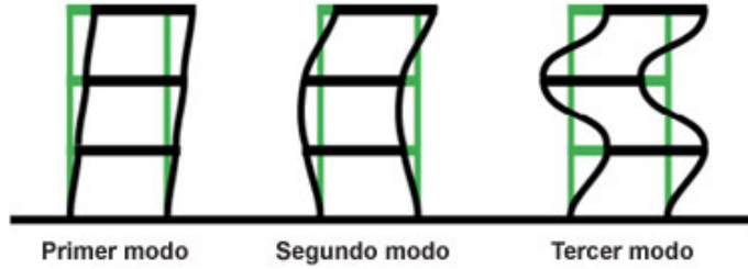
Figura 2.2.3: Forma modal de vibración de un edificio.[30]
