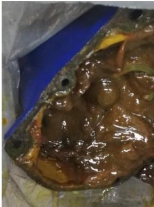
Ilustración 17. Estado inicial del lubricante de la caja de engranajes
