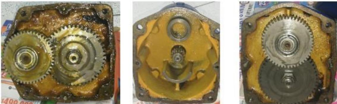
Ilustración 19. Cambio de lubricante caja de engranajes
