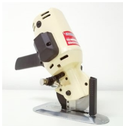
Figura 2-1: Máquina de corte manual con disco giratorio tomado de [46]
