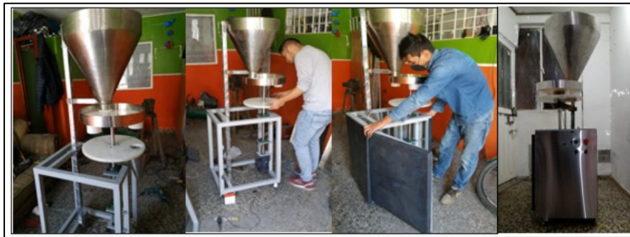
Figura 4-13 Ensamble del sistema de dosificación
