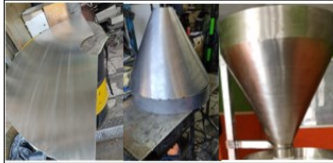
Figura 4-8 Construcción de la tolva
