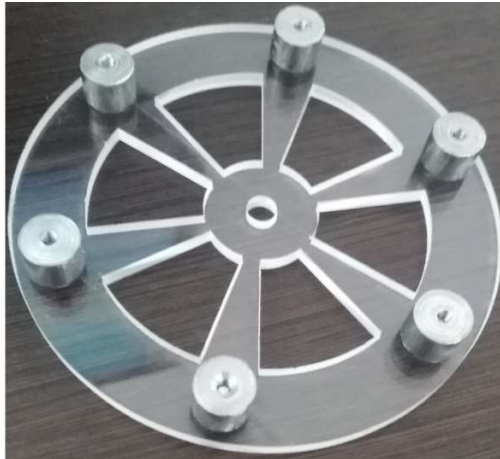
Figura 37. Porta-probetas con un solo material SAE 1018
