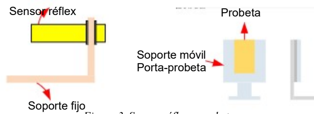
Figura 3. Sensor réflex y probeta
