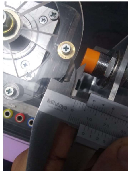
Figura 45. Distancia más lejana de detección sensores
