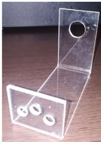
Figura 33. Prototipo de soporte de sensor inductivo/capacitivo inicial (fuente propia)
