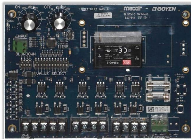
Nota: Los potenciómetros se encuentran ubicados en la esquina superior izquierda de la tarjeta. Mientras que, en la parte inferior, se observan los bornes para realizar la conexión con las válvulas. Fuente: (GOYEN, 2018)
