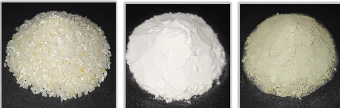
Nota: De izquierda a derecha se aprecia: La partícula de arroz bruto introducida al sistema y el producto obtenido al final del procedimiento de pulverización. El color verdoso es el resultado del proceso de inoculación al que la empresa somete al grano de arroz antes de su trituración.
