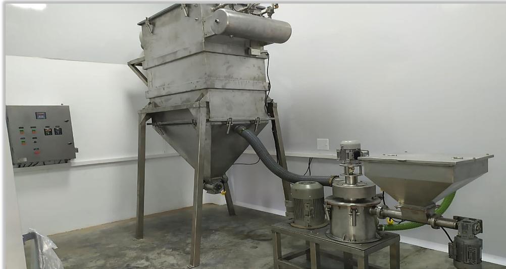
Nota: Captura del sistema de molienda una vez instalado en la planta de producción de la compañía INVESA.
