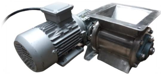
La válvula rotativa es un elemento de descargue que controla el descargue de la tolva del filtro de manera que el aire no presente escapes ni genere contaminación del ambiente de trabajo. Tenga cuidado de no introducir manos ni elementos en la boca de descargue ya que representa riesgo de accidente para el operario y puede dañar los elementos que componen este dispositivo.
