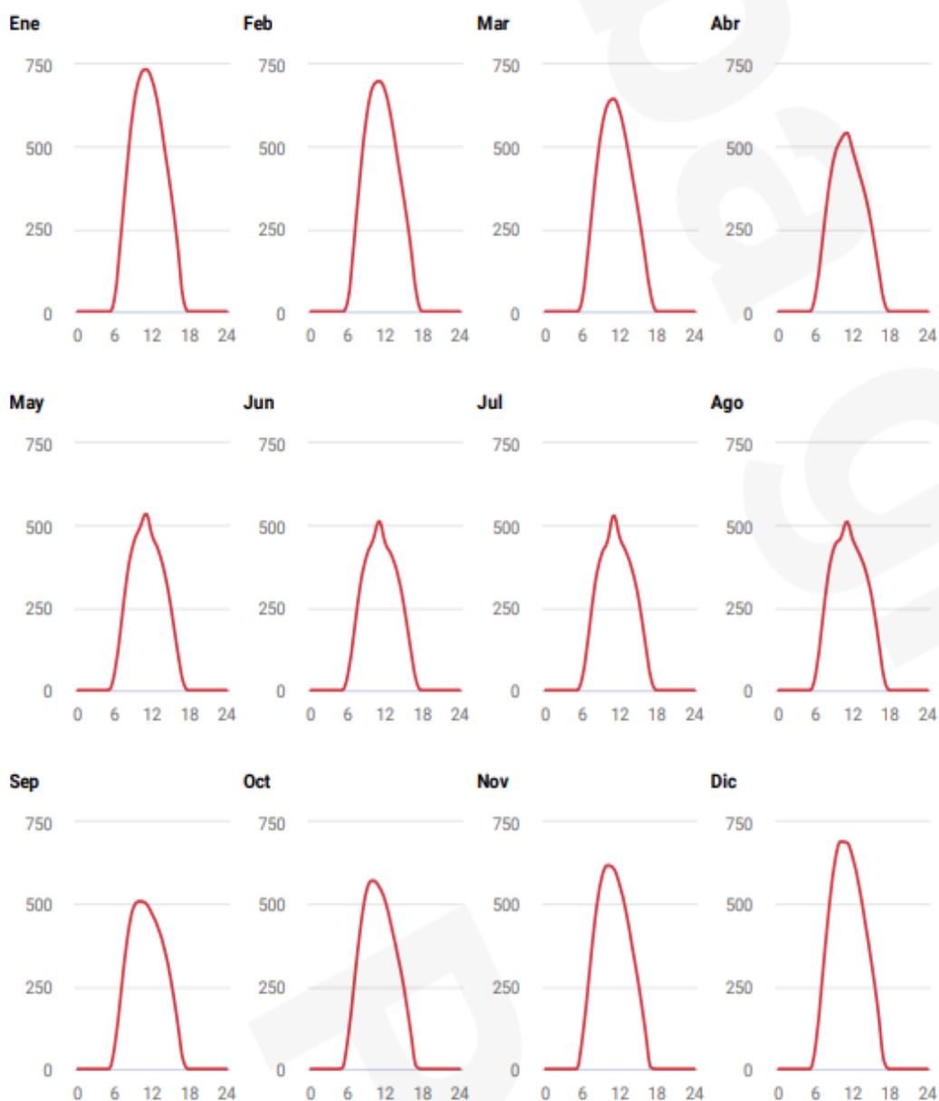
Figura 6.1: Producción eléctrica fotovoltaica específica – promedios horarios
