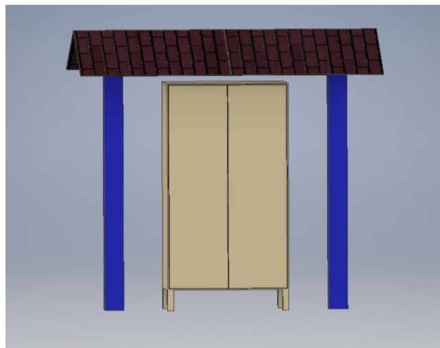
Figura 3.18: Diseño estructura para tablero del sistema eléctrico
