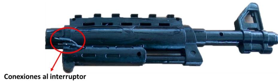
Para la parte de accionar el arma y activar el láser en la [Figura 2-14](#) se aprecia la adecuación de un botón en la parte trasera del gatillo del arma.
