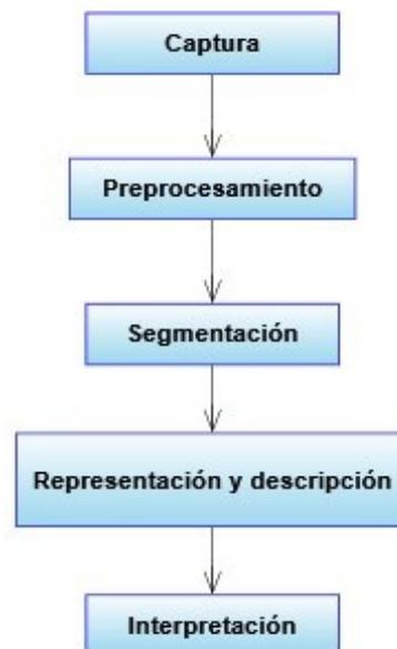
**Captura:** Donde se obtiene la imagen que se desea tratar, si es obtenida a través de una cámara se realiza un proceso de conversión análogo digital en la cual la imagen que es obtenida del mundo real adquiere valores digitales para que la computadora pueda leerla y visualizarla.
