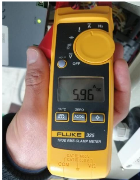
Figura 2-19: Medición del consumo de corriente en el electro-embrague.
