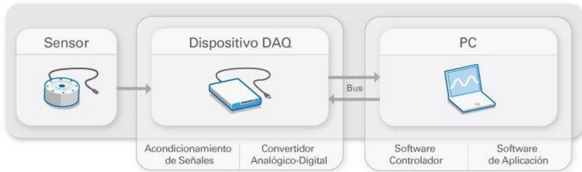
Figura 1-5: Partes de un sistema DAQ.
