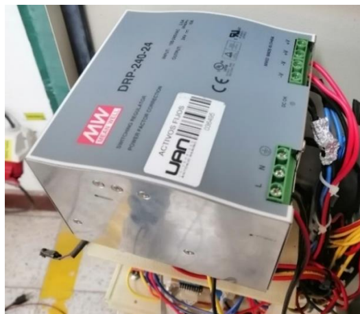
Figura 2-20: Cambio de la fuente de alimentación.
