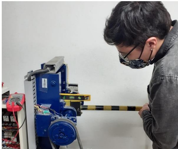
Figura 2-38: Ajuste del péndulo a -90^\circ
