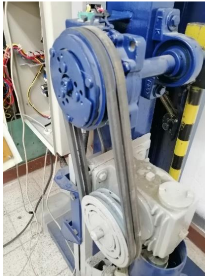
Figura 2-8: Poleas y sistema de transmisión la máquina de impactos Charpy.
