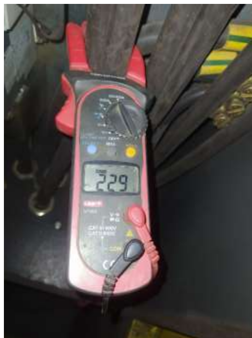
Figura 5: Toma de datos de consumo eléctrico de compresores con diferentes variables en parámetros de carga-vacío.
