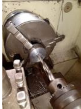
Figura 2-7. Operación de taladrado para el cubo de cada engranaje
