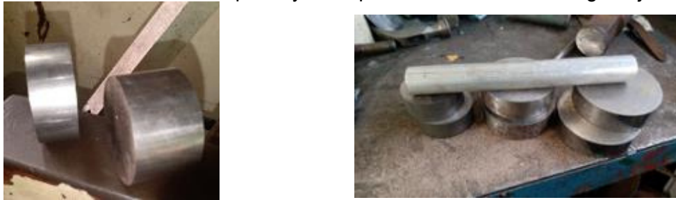
Figura 2-6. Selección de la materia prima y corte para la fabricación del engranaje
