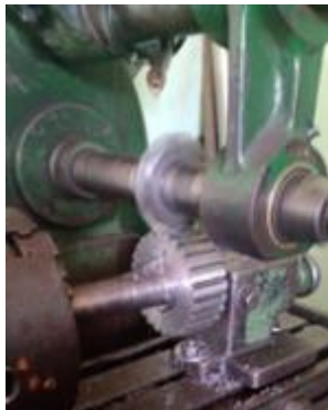
Figura 2-8. Construcción de dientes de los engranajes
