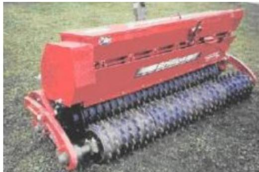
**Figura 9:** (Sembradora específica para pratenses con rodillos acanalado)
