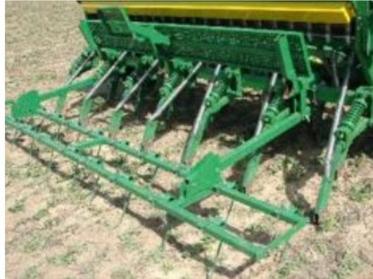
**Figura 10:** (Sembradora con dosificación y tubos de caída independientes)
