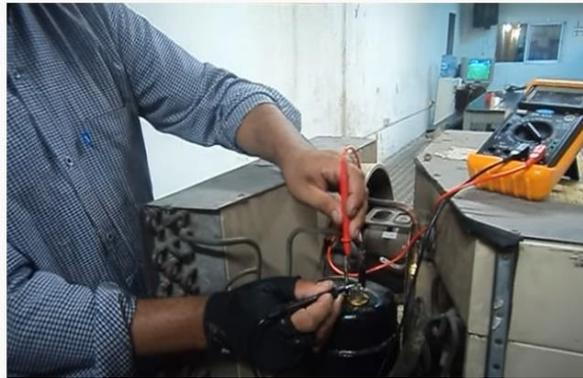
Figura 29. Medición de la línea de alimentación
