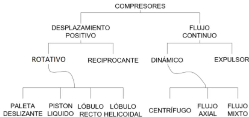
Figura 2. Clasificación de compresores
