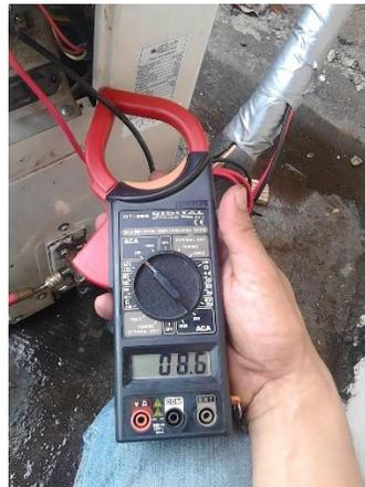
Figura 30. Medición de la línea de alimentación para obtener la intensidad de la corriente eléctrica
