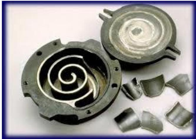
Figura 10. Ruptura de la espiral interna del compresor
